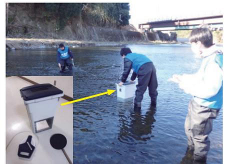
写真2. ゴミ箱に穴を空け、上から覗くと水中が見られる装置
